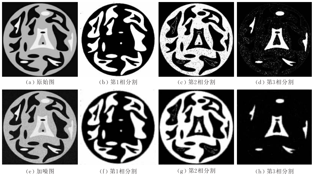
图 2 合成图像分割噪声对比((b)、(c)、(d)为 Sine-Sinc 模型结果;(f)、(g)、(h)为 Sine-Exp-Gauss 模型结果)
