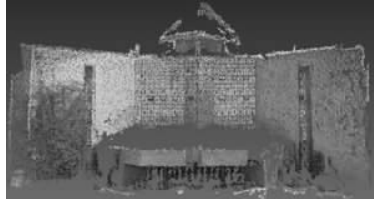
(b) 从左到右: 平移、旋转、缩放变换重建建筑物完整点云模型
