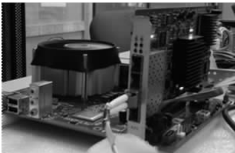
图 6 LabelCast 转发原型系统 NetMagic-Pro
