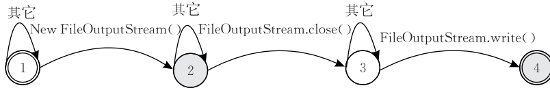
图 9 用于检查 FileOutputSteam 相关“复合式”缺陷的有限状态自动机
