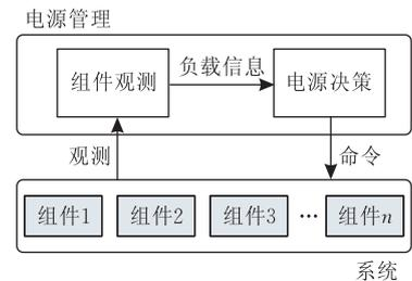
图 2 系统级电源管理的通用机制
