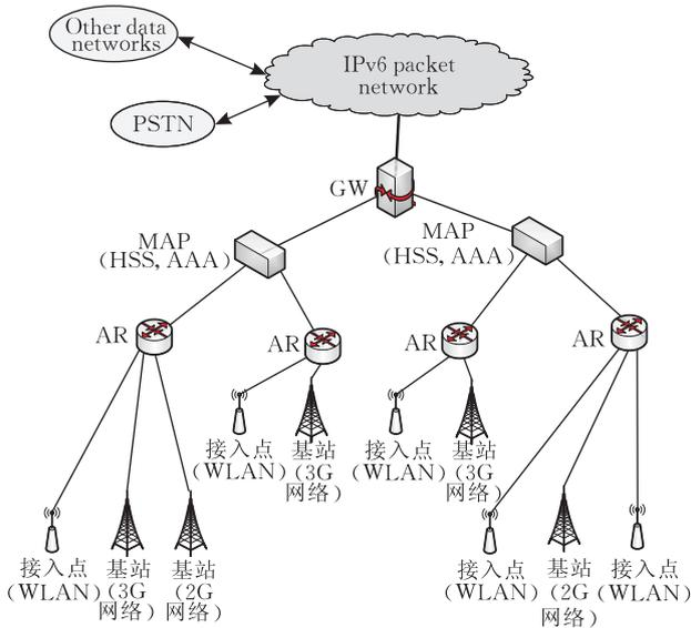
图 5 基于 IPv6 的 NGMN 分层体系结构
