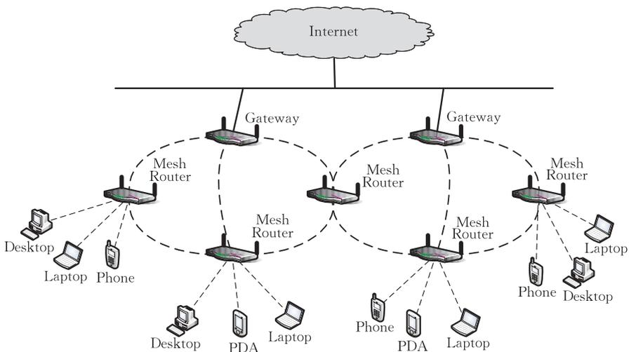
图 9 无线 Mesh 网络结构
