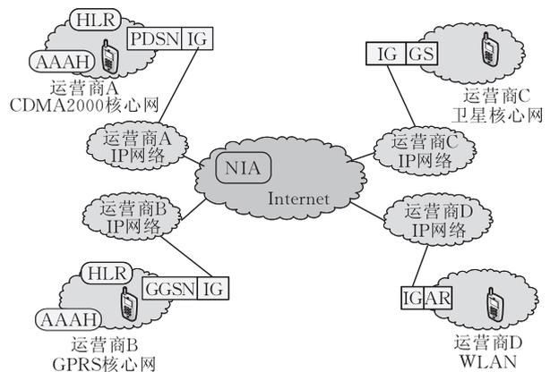
图 4 基于 NIA 的泛在移动通信架构 AMC
