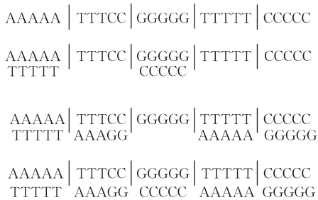
图 1 表示 4 个 2-进制数的存储合成物
