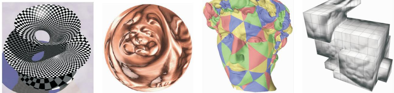
图2 不同类型的参数化:平面参数化<sup>[89]</sup>、球面参数化<sup>[90]</sup>、基网格参数化<sup>[91]</sup>以及多立方体参数化<sup>[92]</sup>
