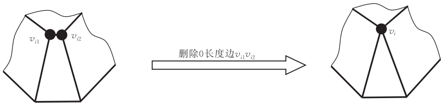
图 9 用操作 2 生成一个超过 3 条边连接的顶点
