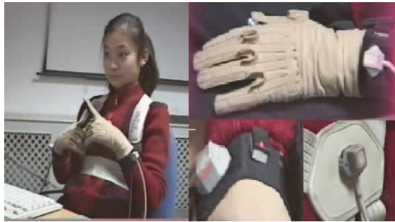
图 8 数据手套和三维跟踪器(3个接收器分别固定在双手和背部)
