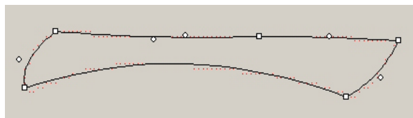
图 2 自动生成的特征点(方点代表轮廓线上曲率较大的点以及沿着轮廓添加的点, 圆点代表 Bézier 曲线控制点)
