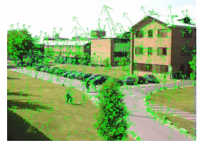
(a) Camera 1 的第1566帧图像 (b) 在(a)中检测出的2491个SIFT特征 (c) Camera 2 的第1566帧图像 (d) 在(c)中检测出的3520个SIFT特征
