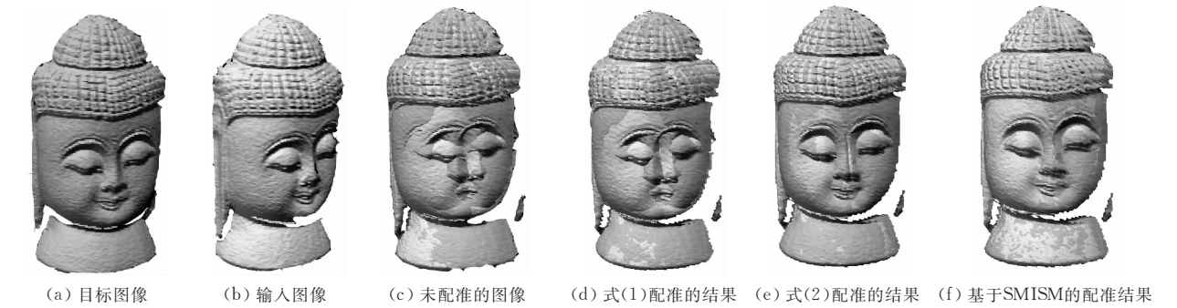
图 2 采用三种不同误差测度进行深度像配准的结果比较
