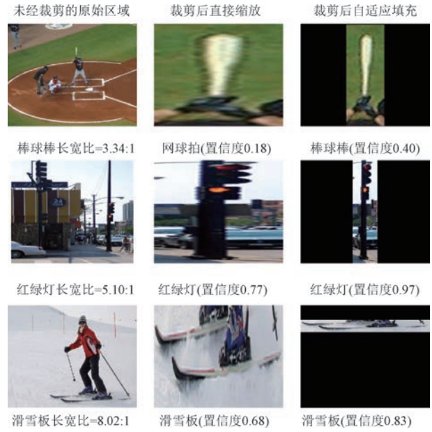
图 2 区域变形对分类性能的影响对比(三列分别为未经裁剪的原始区域、裁剪后直接缩放导致的变形预测结果及分类置信度和裁剪后经过自适应填充策略(APS)处理预测结果及分类置信度)
