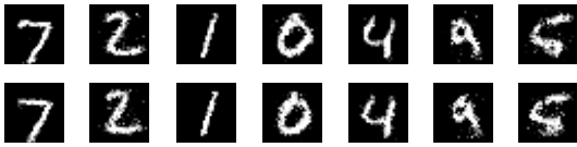
图 8 神经采样 PCD 算法训练出来的 RBM 用于在 MNIST 测试集上做吉布斯重构(从上到下分别表示 m=1,5 的神经采样 PCD)
