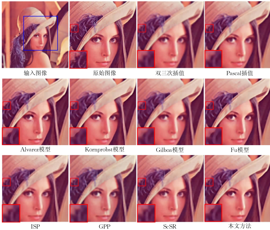
(a) Lena 结果对比 (Alvarez 模型: c_\xi=2, N=14 ; Kornprobst 模型: \tau=6, \alpha_r=1, \alpha_e=1, N=13 ; Gilboa 模型: a=0.5, \theta=\pi/1000, c_\gamma=1, c_\xi=1, N=27 ; Fu 模型: T_1=9, T_2=3, l_1=0.05, l_2=50, N=12 ; 本文模型: c_\gamma=10, c_\xi=1, N=19 )
