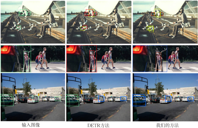
图 6 使用 DETR 和我们的方法模型对图像中被遮挡物体的检测效果示例
