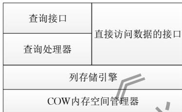
图 7 SwingDB 的架构
