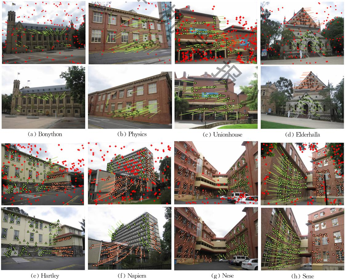
图 8 本文所提出的 NPMF 方法在平面单应性估计上获得的一些结果(不同结构的内点用不同的颜色表示).第 1 行和第 3 行分别表示带有真实模型实例标签的图像(视图 1),第 2 行和第 4 行分别表示 NPMF 在视图 2 上获得的结果(线条的始端与视图 1 的标签对应)
