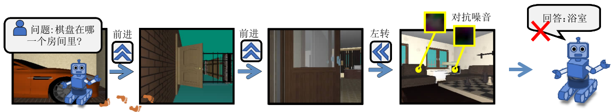
图 4 基于环境的对抗攻击示例 [45] (通过在仿真环境中的 3D 目标物体上加入对抗纹理信息, 该方法能够有效地迷惑 EQA 机器人, 让其对于问题给出错误的回答或执行错误的路径规划)
