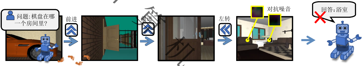
图 4 基于环境的对攻击示例 [45] (通过在仿真环境中的 3D 目标物体上加入对抗纹理信息,该方法能够有效地迷惑 EQA 机器人,让其对于问题给出错误的回答或执行错误的路径规划)
