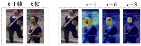
(a) 由于检测误差导致相邻帧出现空间不对齐 (b) 帧标注位置与 k-1 帧所有位置的特征相似图(使用合理的 \tau , CBFM-A能在相邻帧中定位到同一部件的区域)
