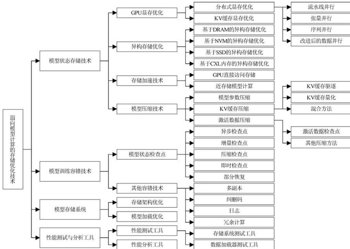
图 46 面向模型计算的存储优化技术
