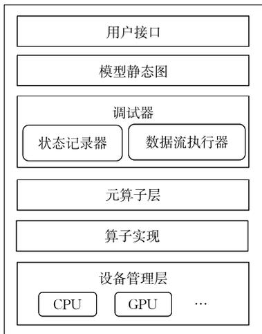
图 3 深度学习框架缺陷检测工具系统架构图
