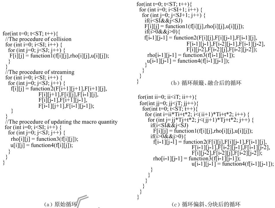
图 2 LBM 计算程序的循环变换过程
