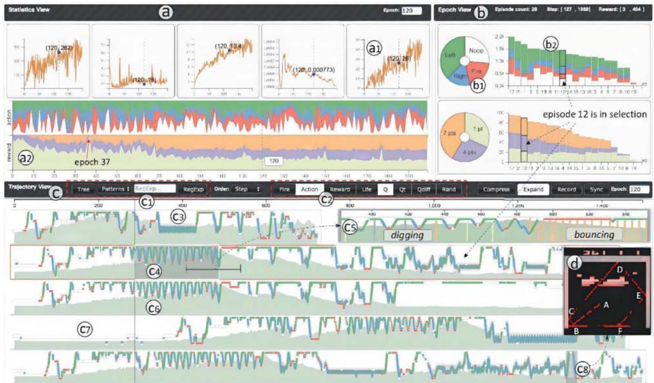
图8 雅达利游戏环境下强化学习算法训练的可视化 [119] (a)统计视图用折线图和堆叠区域图显示整体训练统计数据; a1表示训练统计数据的折线图; a2表示训练统计数据的堆叠区域图; (b)训练周期视图用饼图和堆叠柱状图显示每个训练周期的统计数据; b1表示每个训练周期统计数据的饼图; b2表示每个训练周期统计数据的堆叠柱状图; (c)轨迹视图揭示了智能体在不同轨迹中的动作和奖励; C1-C7分别代表了智能体不同的轨迹片段信息; (d)片段视图显示了智能体游戏中的内容)
