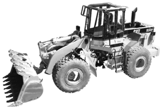
(a) 激光扫描重建的点云模型
