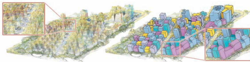
图1 面向三维城市点云的建筑实例分割与结构化重建实例(原始点云数据量大,缺少语义标注,难以交互(左图);重建后建筑被精准标注,具有清晰的几何边界以方便交互,同时数据量得到简化(右图))
