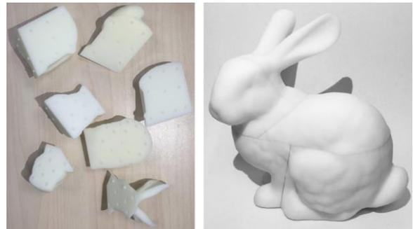
图 11 使用数字几何处理将模型分割打印再组装的方法具有诸多不足，如图中所示具有较明显的缝隙
