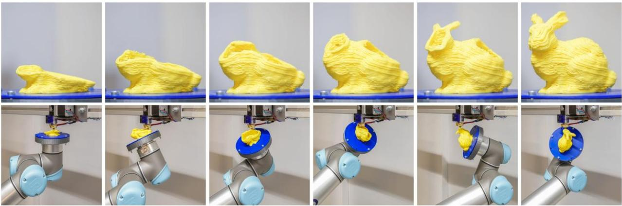
图3 使用六自由度机器人手臂沿着空间曲面层打印无支撑兔子模型<sup>[44]</sup>
