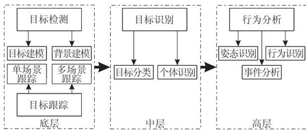
图 1 智能视频监控算法流程
