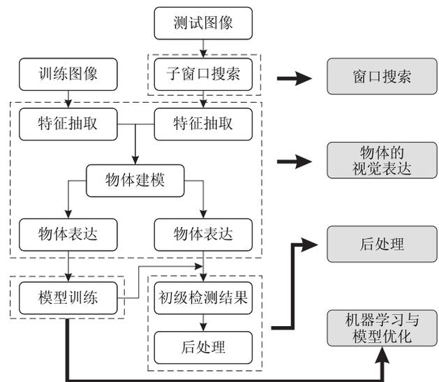
图 4 基于滑动窗口的目标检测系统框架
