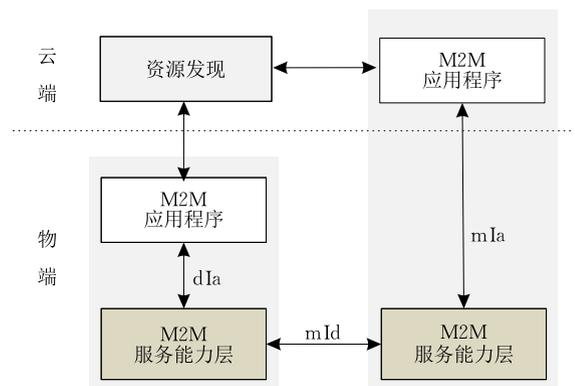
图 9 M2M 体系结构参考模型
