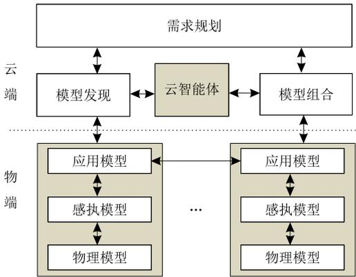
图 6 PMDA 体系结构参考模型
