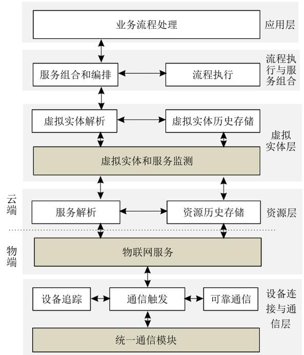
图 11 IoT-A 体系结构参考模型
