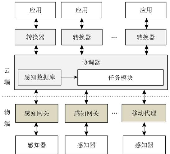
图 7 SenseWeb 体系结构参考模型
