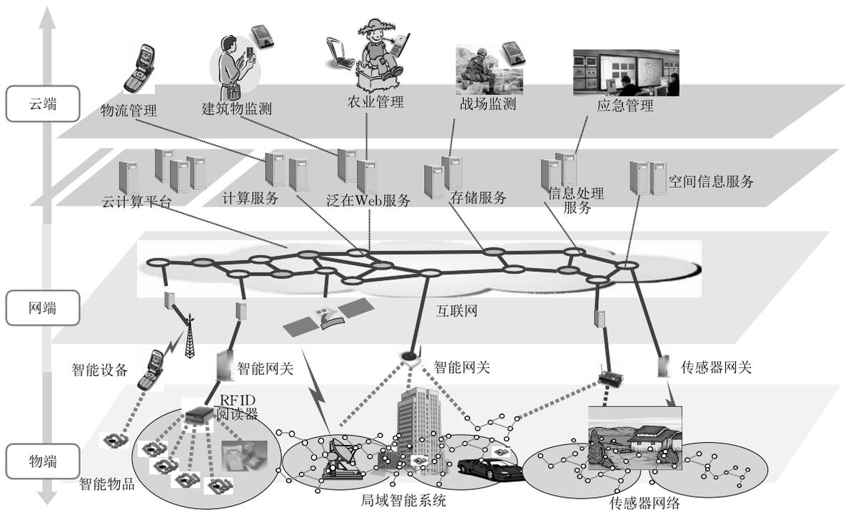
图 1 物联网系统的组成架构<sup>①</sup>
