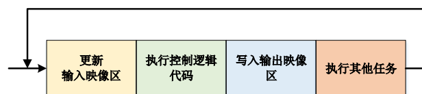
图 1 PLC 代码的循环扫描方式
