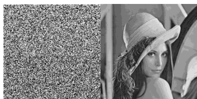
(d) 载密图像 (e) 恢复的图像 (嵌入率 r=2.617 bpp) (PSNR \rightarrow+\infty ,SSIM=1)
