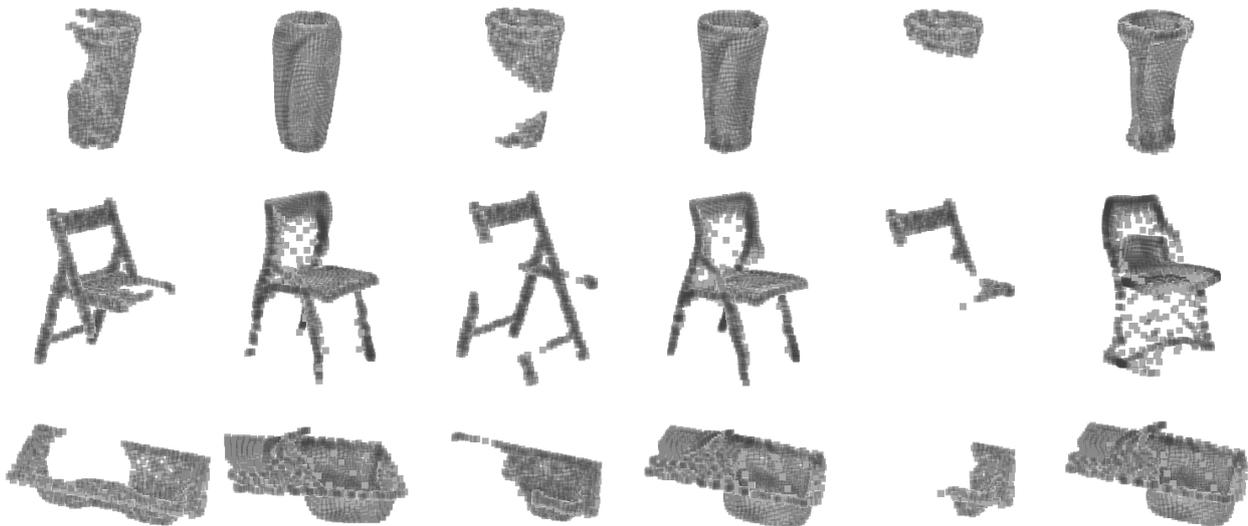
(a)缺失 25%的输入 (b)缺失 25%的补全 (c)缺失 50%的输入 (d)缺失 50%的补全 (e)缺失 75%的输入 (f)缺失 75%的补全
