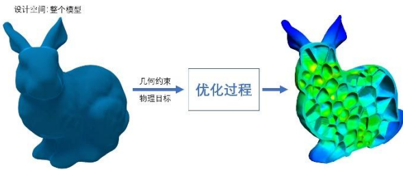
图5 自上而下的结构设计流程。设计空间为整个输入模型，根据几何约束及物理目标确立优化算法，再根据边界条件完成模型内部结构的求解 [29]
