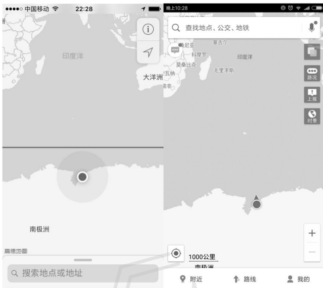
图 11 GPS 欺骗手机效果图（左侧测试手机为 iPhone6，测试软件为高德地图；右侧测试手机为红米 note4，测试软件为百度地图）
