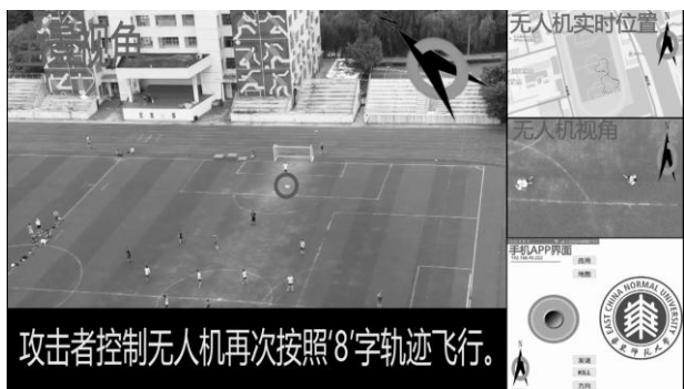
图 12 控制无人机按照‘8’字轨迹飞行 利用上述动态改变欺骗点的 GPS 欺骗系统和
