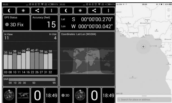
图 7 GPS 欺骗手机效果图（测试手机为小米 5 和 iphone6）
