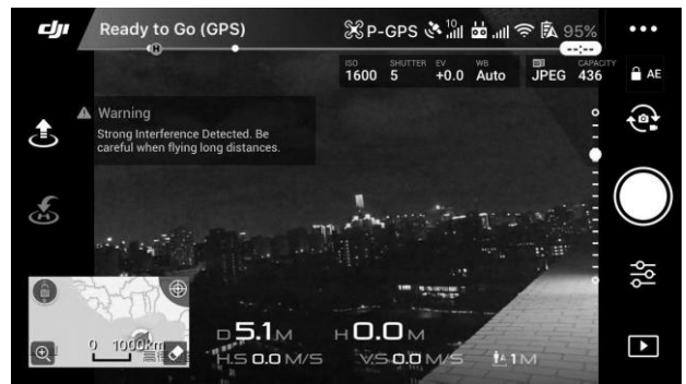
图 9 GPS 欺骗无人机效果图 2（测试无人机为大疆精灵 3 标准版）
