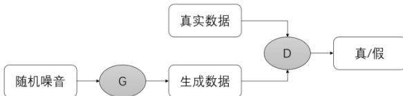
图10 生成对抗网络模型示意图
